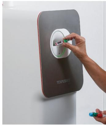
Tempus 600 – это автоматизированное решение для обработки, учета и транспортировки заданного количества проб на любые расстояния. Модуль отправки Tempus 600 может подключаться напрямую к устройствам загрузки россыпью и к системам автоматизации лабораторий различных производителей и поставщиков средств ИВД, оптимизируя процесс подачи проб и превращая Tempus 600 в ключевой компонент преаналитического процесса.
