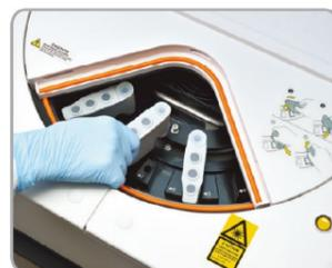
Автоматическое бесконтактное перемешивание реагента с парамагнитными частицами
