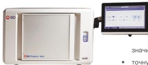
Система BD Phoenix M50 обеспечивает микробиологической лаборатории возможность одновременного проведения идентификации (ИД), определения чувствительности к антибиотикам (ОЧА) и многое другое:
