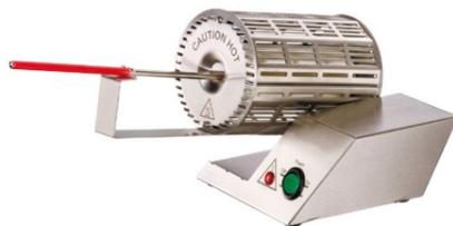
E-Loop — электрический стерилизатор (обжигатель) инокуляционных петель и игл. Стерилизация инфракрасным излучением происходит внутри керамического цилиндра при темпе-
